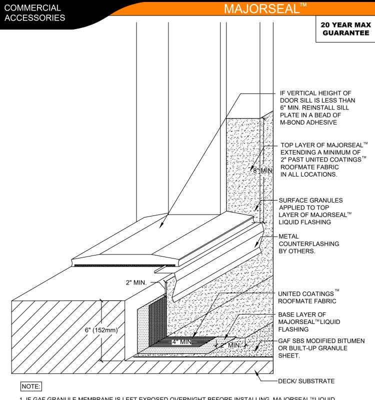
1. IF GAF GRANULE MEMBRANE IS LEFT EXPOSED OVERNIGHT BEFORE INSTALLING MAJORSEAL™LIQUID FLASHING, A TEMPORARY NIGHT SEAL MUST BE INSTALLED. THE NIGHT SEAL MUST BE COMPLETELY REMOVED BEFORE INSTALLING THE FLASHING.
