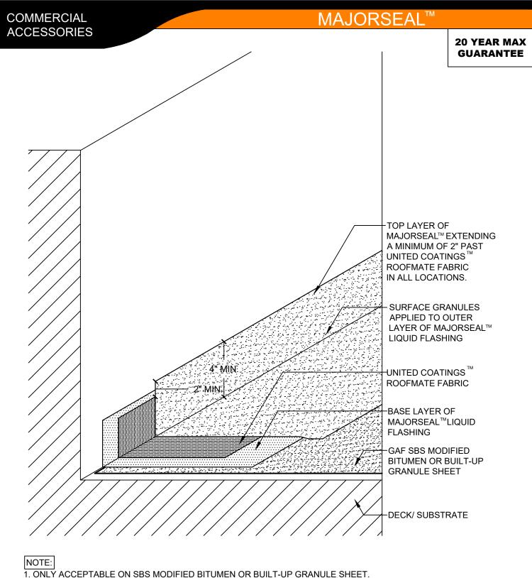
2. IF GAF GRANULE MEMBRANE IS LEFT EXPOSED OVERNIGHT BEFORE INSTALLING MAJORSEAL™ LIQUID FLASHING, A TEMPORARY NIGHT SEAL MUST BE INSTALLED. THE NIGHT SEAL MUST BE COMPLETELY REMOVED BEFORE INSTALLING THE FLASHING.
